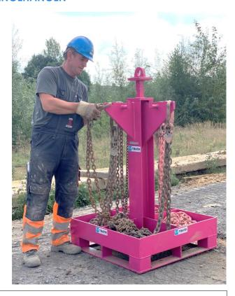
Zum Einhängen wird das Kettengehänge z.B. vom Bagger abgenommen und an einen der 12 Haken aufgehängt. Die Entnahme geschieht in umgekehrter Reihenfolge.
