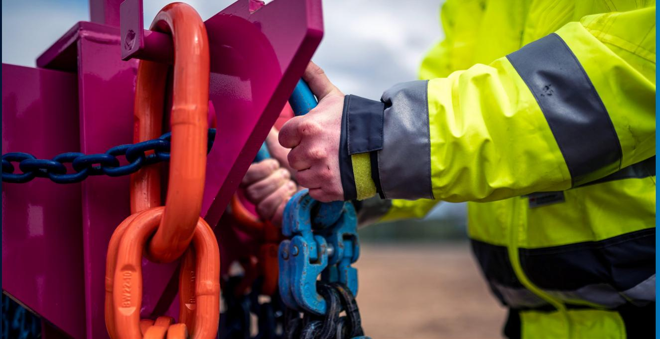
Zum Einhängen wird das Kettengehänge z.B. vom Bagger abgenommen und an einen der 12 Haken aufgehängt. Die Entnahme geschieht in umgekehrter Reihenfolge. Der Vorgang findet durchweg in aufrechter Haltung statt.
