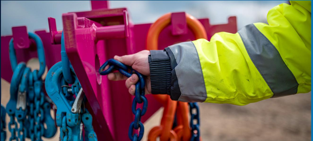
Zum Schutz vor Diebstahl kann eine hochfeste Kette (Güteklasse 10; Länge ca. 1,5 m; Ösenstärke  $\geq 10$  mm) durch alle Aufhänger der Kettengehänge und durch die Arme des Kettenständers gezogen werden. Die Enden der Ketten werden dann mit einem Bügelschloss (Schutzklasse 10) verriegelt.
