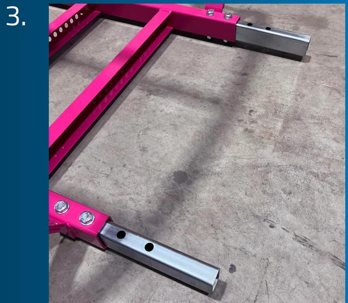
Die Verschraubung der Zwischenstücke erfolgt mit jeweils 4 Schrauben M12 (SW19, Festigkeit min. 8.8) mit selbstsichernden Muttern.
