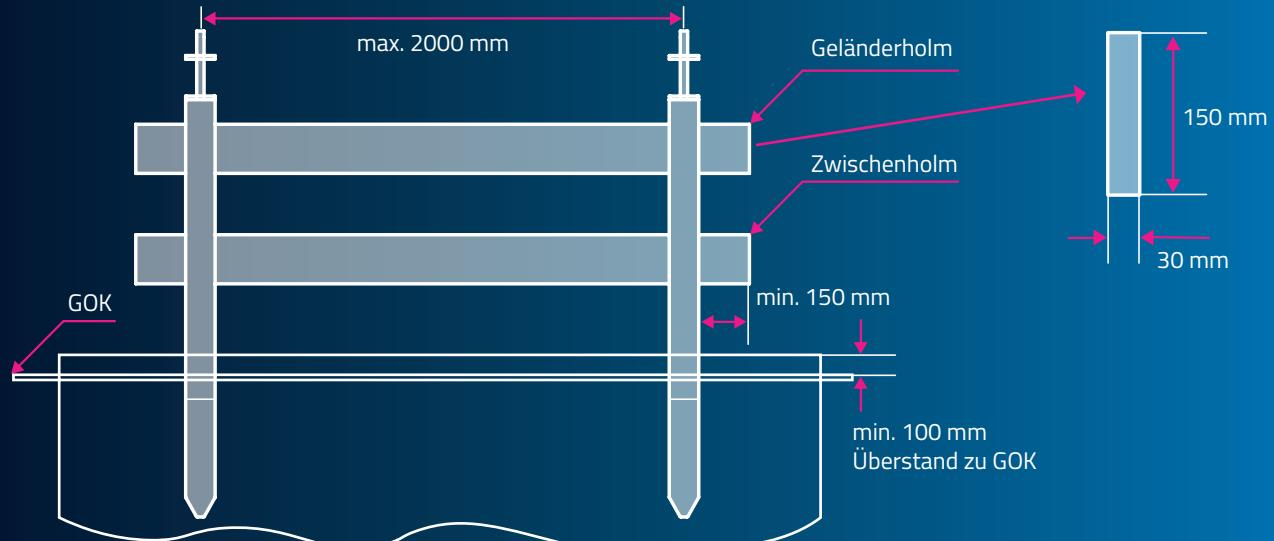
Abmessungen bis 2000 mm Pfostenabstand
