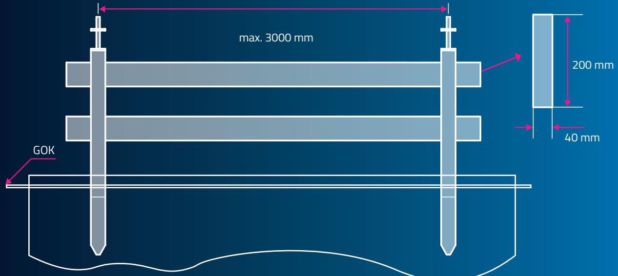
Abmessungen ab 2000 mm Pfostenabstand
